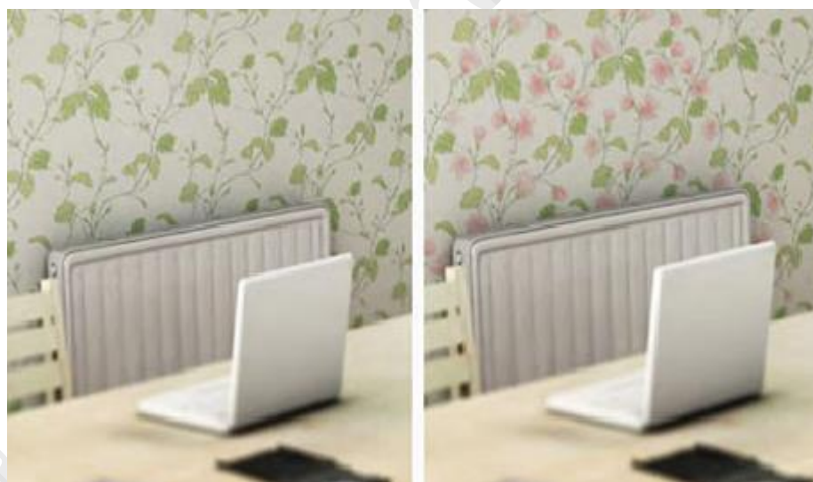
شکل ۵ تغییر رنگ دیوار با افزایش دما با دلیل روشن بودن رادیاتور
