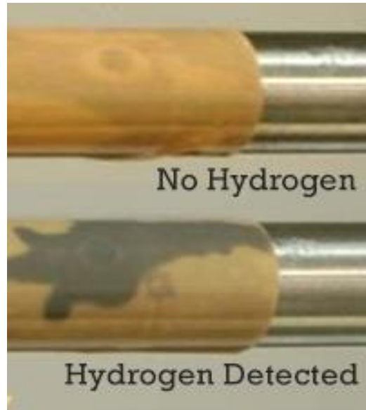
شکل ۱۱ شناساگر هیدروژن؛ برچسب مواد کیموکرومیک که با حضور هیدروژن تغییر رنگ می‌دهد.
