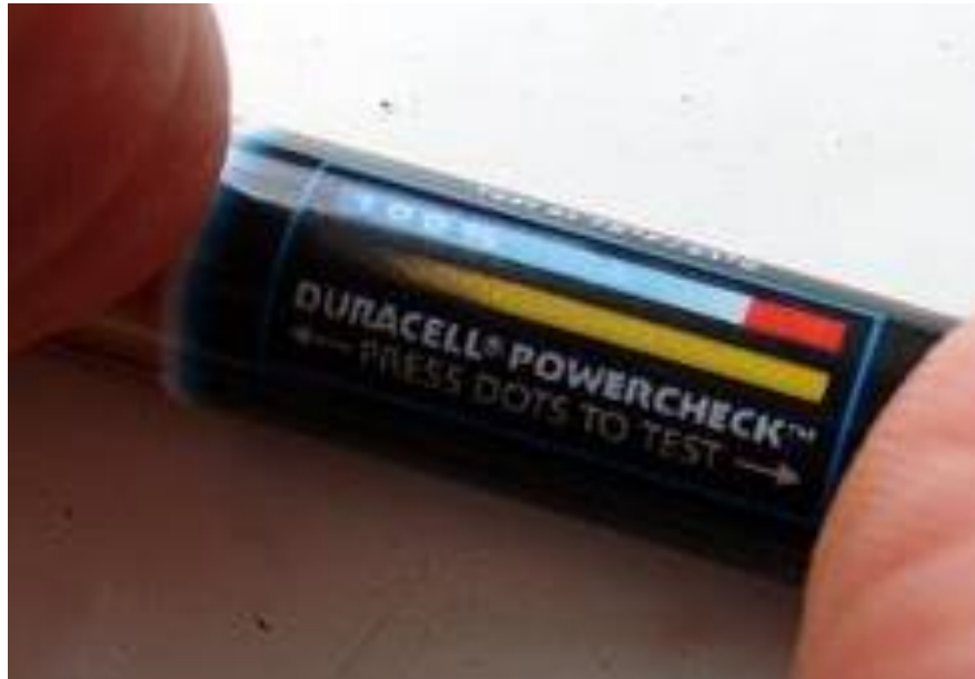
شکل ۶ سنجه باتری ساخته شده با مواد ترموکرومیک
