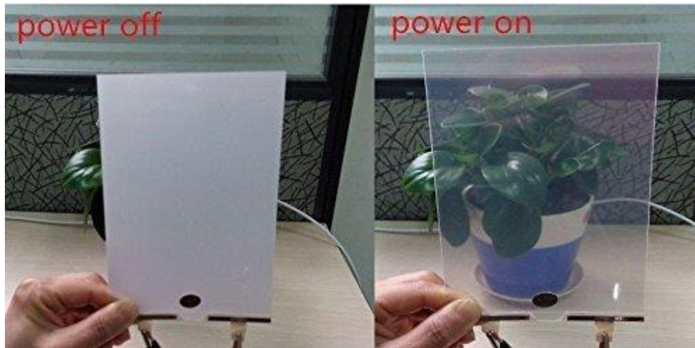
شکل ۹ صفحه کتابخوان الکتروکرومیک؛ شفافیت صفحه با اعمال ولتاژ تغییر می کند.
