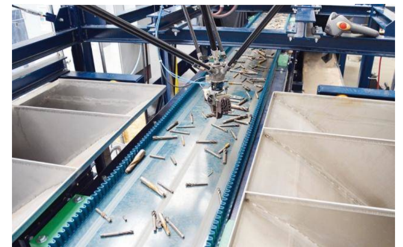
کارخانه آزمایشی بازیافت فلزات که در پروژه PLUS ایجاد شده است. این پروژه با بهره‌گیری از یک فرآیند مرتب‌سازی مبتنی بر لیزر توسعه یافته است که به کمک آن می‌توان آلیاژهای با ارزش را به طور موثر از ضایعات فلزی بازیابی کرد.
