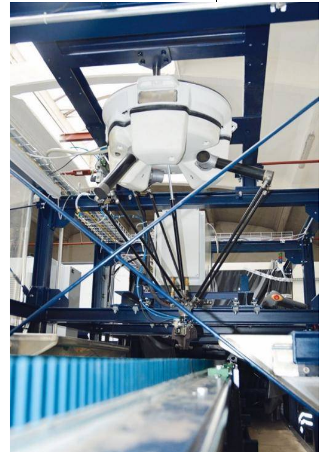
کارخانه آزمایشی بازیافت فلزات که در پروژه PLUS ایجاد شده است. این پروژه با بهره‌گیری از یک فرآیند مرتب‌سازی مبتنی بر لیزر توسعه یافته است که به کمک آن می‌توان آلیاژهای با ارزش را به طور موثر از ضایعات فلزی بازیابی کرد.
