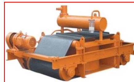
دستگاه جاذب مغناطیسی تفکیک زباله
