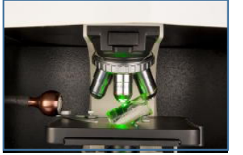
آنالیز رامان توسط میکروسکوپ ساخت شرکت تکسان با هارمونیک دوم لیزر Nd-YAG
