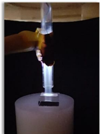
یک نمونه مشعل پلاسمایی که با تاباندن پلاسما بر سطح، آن را اصلاح و تمیز می‌کند.
