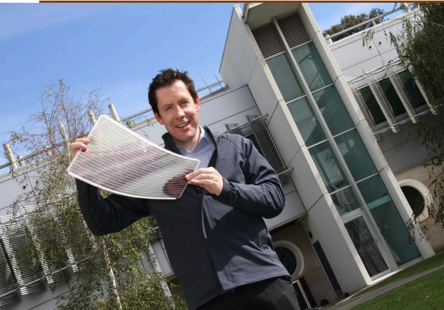
شکل ۲. سلول ارگانیک ساخته شده به روش پرینت سه‌بعدی در کنسرسیوم VICOSC استرالیا
